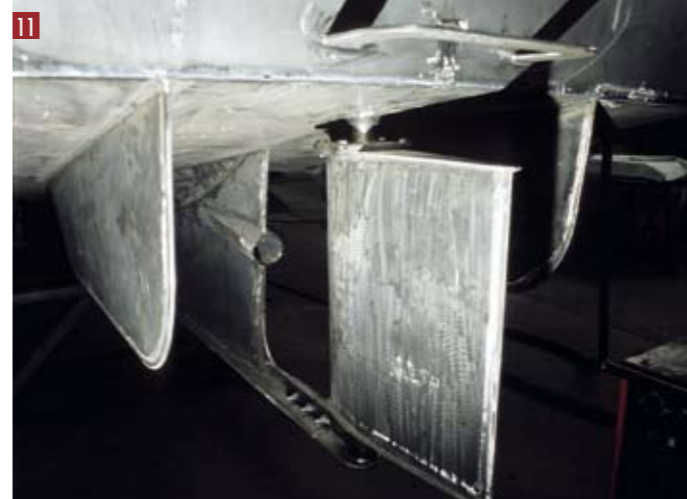
6 Kombuis. 7 Standaard heeft de MN 950 een buitenstuurstand. 8 Vrijstaand bed in de voorpiek. 9 Hoekbank met tafel in de salon. 10 Motor in stalen bekisting met geïsoleerde uitlaat. 11 'Stuurkielen'.
